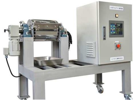
**○熱回収型ドラムドライヤ乾燥装置**
